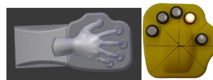
Figura 2. Modelo 3D y Prototipo 3D impreso.
