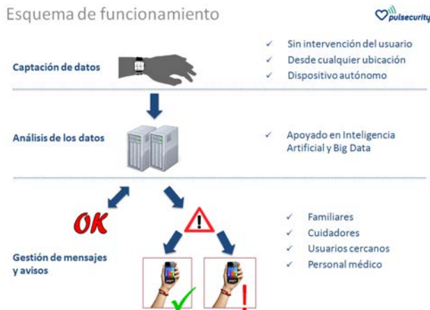
Figura 1. Esquema del sistema Pulsecurity.
