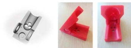
Figura 5. a) Prototipo 3D elaborado a través de la software open source CURA-3D (izquierda). b) Pieza física impresa en Witbox2 (derecha)
