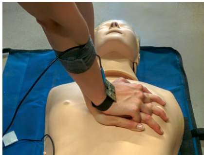
Figura 2. Acelerómetro situado en la muñeca del rescatador
