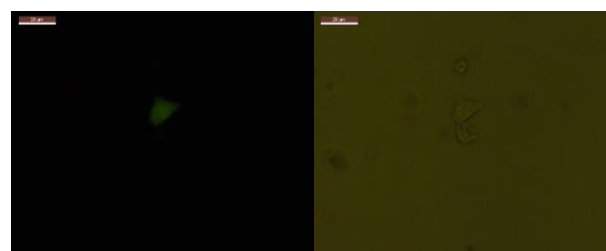
Figura 2 Prueba de viabilidad de células en hidrogeles de HA en 3D. Izquierda, imagen de fluorescencia. Derecha, imagen en campo claro.
