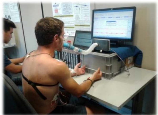
Figura 2. Sistema de adquisición del flujo respiratorio y la presión inspiratoria.
