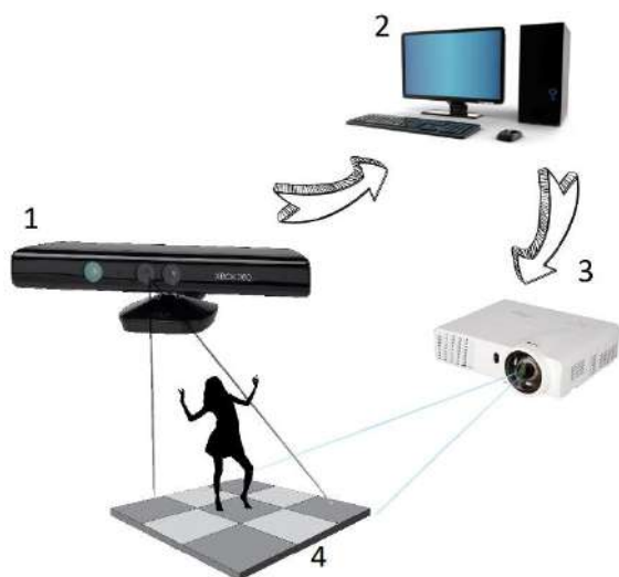
Figura 2. Sistema de baile formado por una cámara Microsoft Kinect (1), un ordenador básico (2), un proyector Optoma X305ST (3) y una zona proyectada en el suelo por el proyector y donde la cámara está enfocada para hacer el tracking (4).
