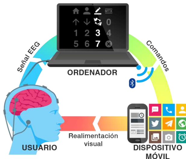
Figura 1. Estructura general del sistema BCI desarrollado.
