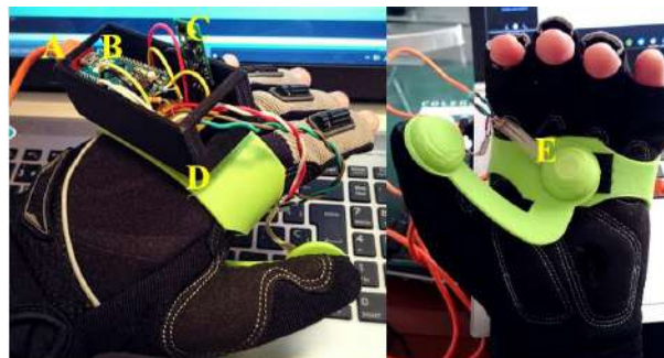
Figura 1. Previous versión: A-computer, B-Arduino, C-AltIMU, D-box and strap, E- FSR Button.
