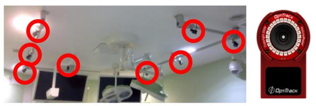
**Figura 3.** Sistema de guiado *Optitrack* colocado en las barras metálicas (izquierda). Cámara *Optitrack* (derecha)
