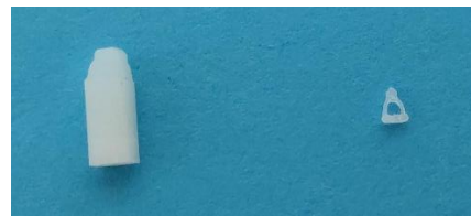
Figura 5. Estribo impreso en 3d antes y después del procedimiento de limpieza.
