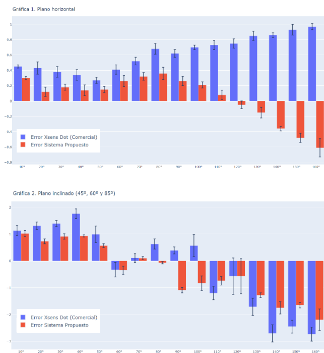
Precisión del sistema propuesto y sensores comerciales en configuración de dos sensores sobre plano horizontal, ( Gráfica 1 ) y sobre planos inclinados 45°, 60° y 85° ( Gráfica 2 ), respecto a las tomas de medidas de 10° a 160° de un goniómetro digital.
