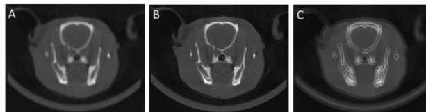
Figura 4. Corte axial del roedor 1 reconstruido con diferentes valores de desp-x : 1.9 mm (A), -0.5 mm (B), -3.8 mm (C).
