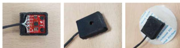
Figura 3. Sensor de aceleración y sistema de fijación mediante adhesivo reusable.
