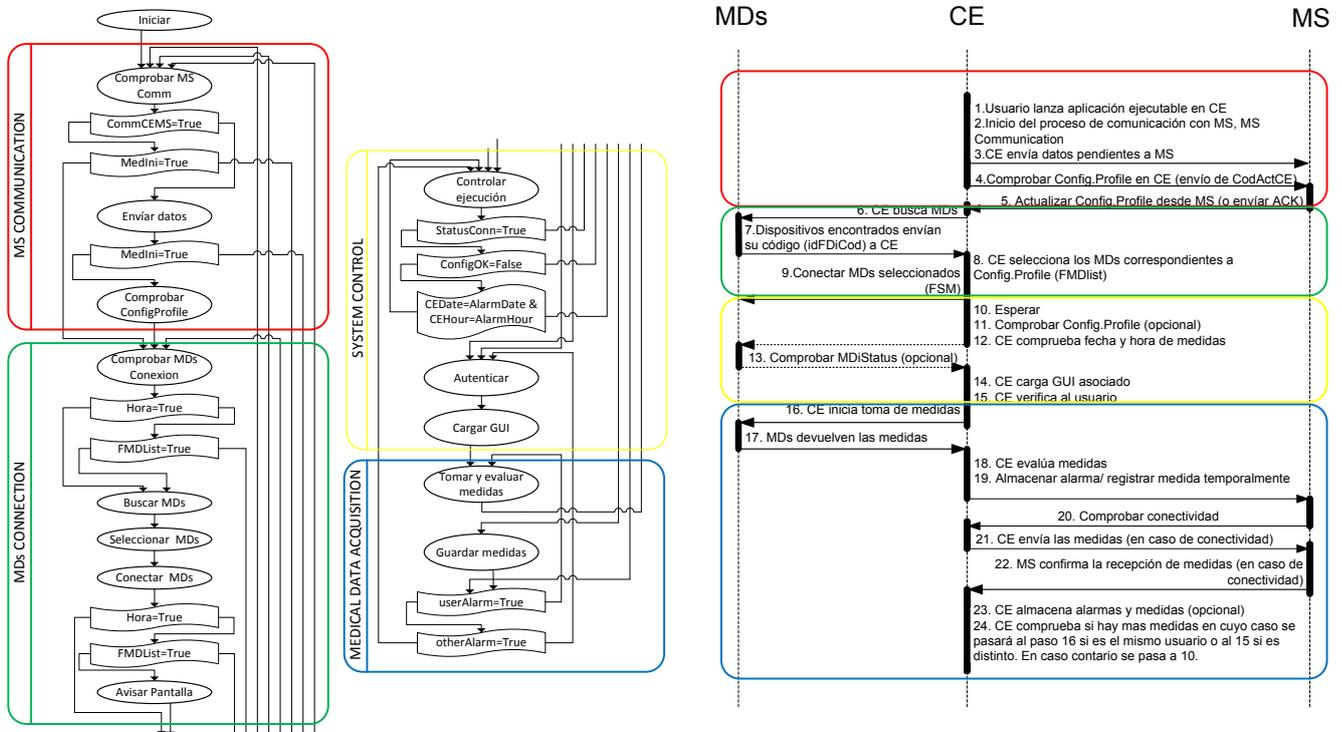
Figura 2. Diseño funcional y modelo de comunicaciones
