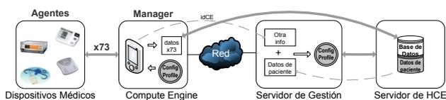
Figura 3. Papel del Config.Profile en la plataforma
