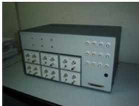
Figura 5. Sistema hardware del fantoma multicanal
