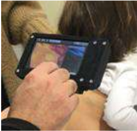
Figura 2. Ilustración de como el sistema es usado para estudiar a un paciente. El hemangioma es analizado sin tocar al paciente. La distancia entre el dispositivo y la lesión es fija.
