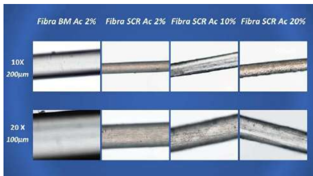
Figura 1. Imágenes de las fibras en seco de los distintos tratamientos observadas con el microscopio óptico a microescalas 200 y 100 µm
