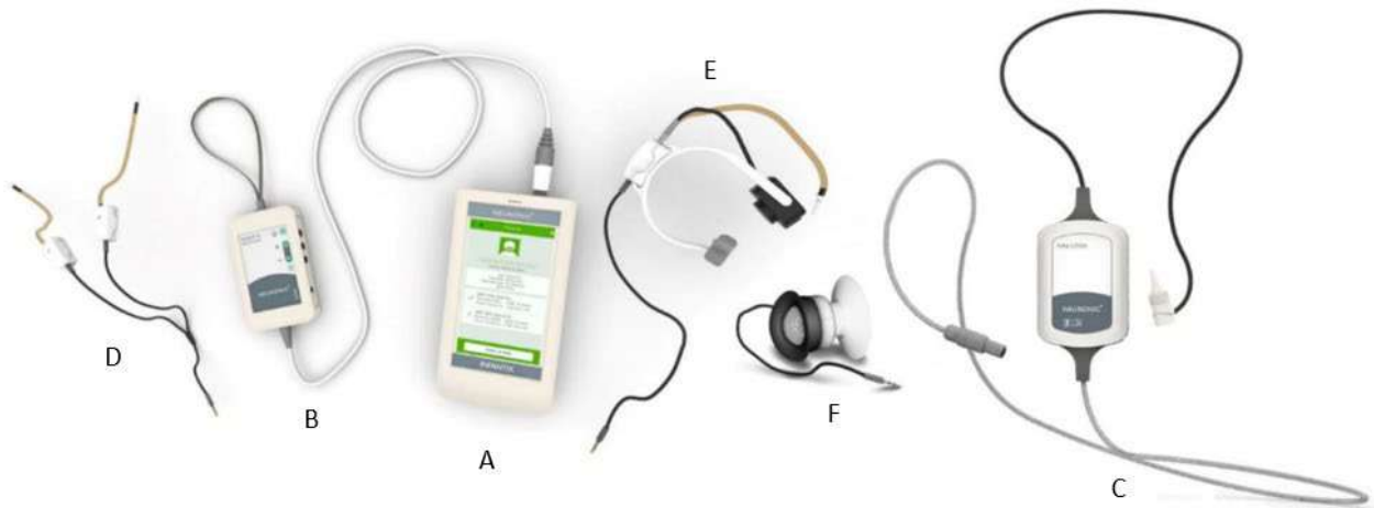
Figura 1. Sistema de Cribado Neonatal INFANTIX NA6.2. A: Módulo de Control, B: Módulo de Registro y Estímulo de Potenciales Evocados Auditivos y Visuales, C: Módulo de Emisiones Otoacústicas, D: Transductor Aéreo, E: Transductor Aéreo-Óseo and F: Estimulador Goggle.
