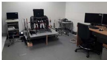
Figura 1. El simulador de propulsión en SRM del LIO
