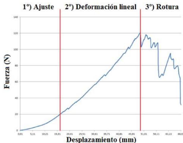
**Figura 3.** Gráfica obtenida en uno de los ensayos de tracción a modo de ejemplo
