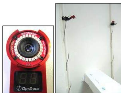
Figura 2. Sistema de posicionamiento óptico. Cámara OptiTrack FLEX: V100R2 (izquierda) y zona de trabajo con las dos cámaras infrarrojas (derecha)
