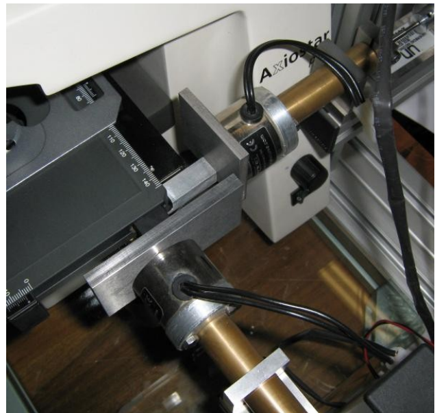
Figura 3. Acople del microscopio con los electroimanes
