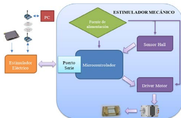
Figura 1. Diagrama general del estimulador electromecánico.
