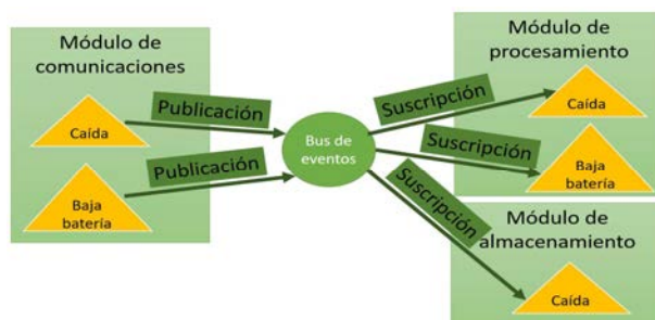
Figura 2. Modelo de comunicación entre módulos de la aplicación.
